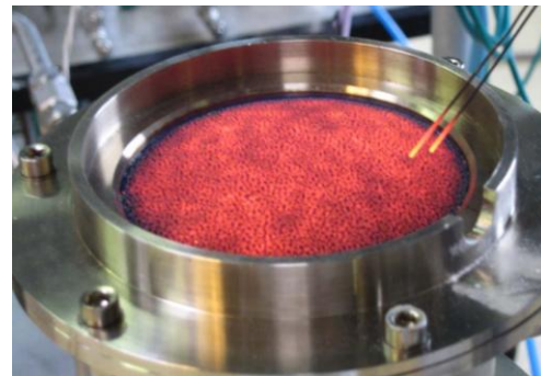
Brûleur catalytique en fonctionnement : il n'y a pas de flamme
